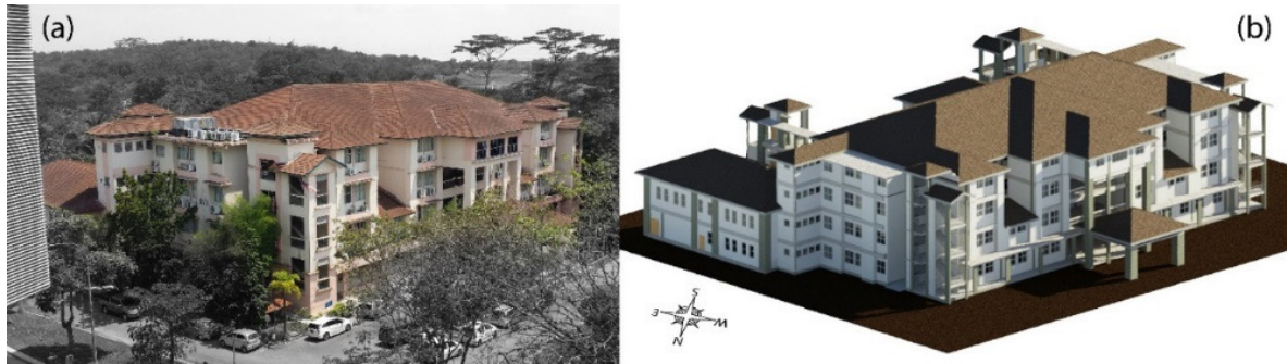
الشكل رقم (٢٢). دراسة حالة مبنى قائم (أ) صورة، (ب) نموذج نمذجة معلومات المباني (Lim et al., 2019)
